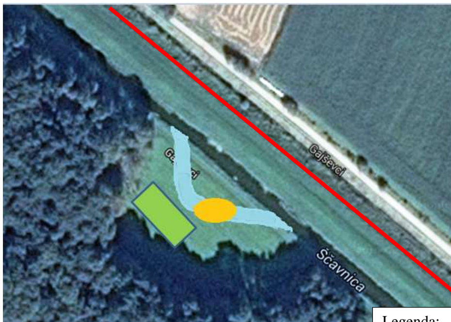
Slika. Umestitev ERM v prostor: vegetacijski pas, stranska bazenom in trstična greda za izsuševanje mulja
